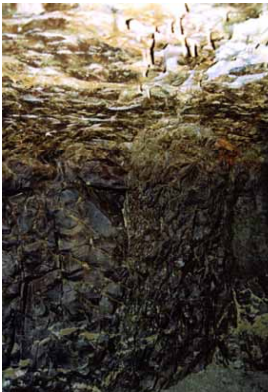
写真11 北側の壁に見られる断層破碎帯
